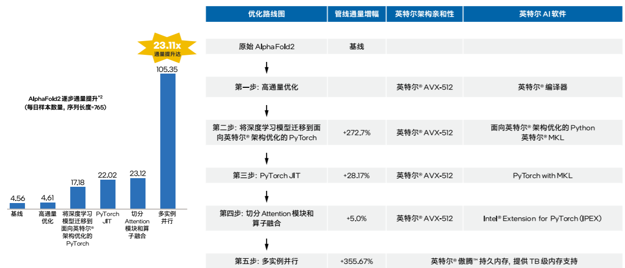
图 2-7-8 基于第三代英特尔® 至强® 可扩展处理器的优化流程中多种优化措施带来的累计性能提升 70
