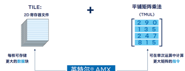
图 3-2 英特尔® AMX 架构由 2D 寄存器文件 (TILE) 和 TMUL 组成
