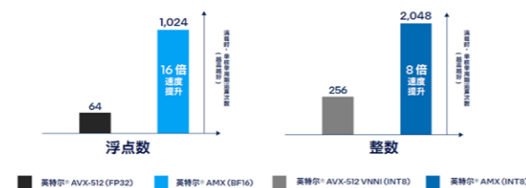
图 3-3 与英特尔® AVX-512_VNNI 相比，英特尔® AMX 在处理 INT8 和 BF16 两种数据类型时表现更出色 8
