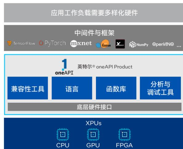
图 6-6 英特尔® oneAPI 工具套件架构
