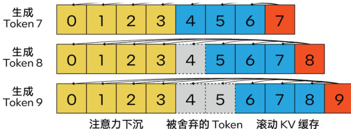
图2. Steaming LLM 的 KV 缓存 ( 图片来源: [通过注意力下沉实现高效流式语言模型](#) )
