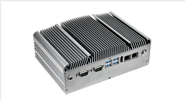
CBX-29B0是一个款新型的无风扇工控机, 搭载 Intel Tiger Lake平台处理器, 支持DDR4 3200 Mhz, 最大支持32GB, 整机小巧, 支持嵌入式、壁挂式和桌面式三种安装方式, 可满足客户多种需求, 可广泛应用于终端、机器视觉、工业自动化、数据采集等工业控制领域。
