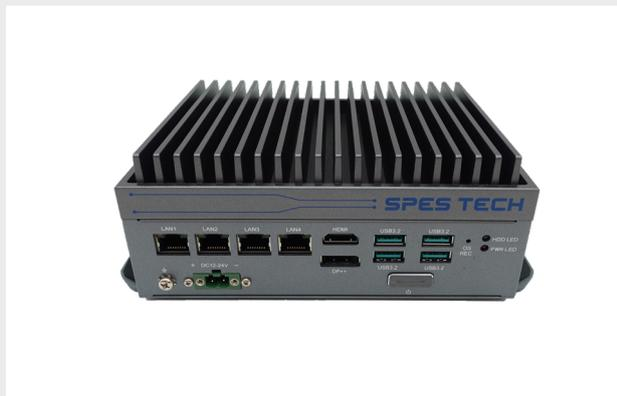
CIS-RTLU-LW01是一款无风扇高性能边缘计算设备，产品搭载英特尔®第11代TigerLake UP3平台，高算力性能强势助推设备运转。12~24V的宽压输入，兼容各类工业制造用电环境。根据机器视觉应用特性，配置4个高稳定性英特尔®千兆网口，同时具备各类串口、GPIO、CAN 2.0B，具有4K HDMI，DP++ 双显示等功能，实时反馈检测结果，助力高效生产。
