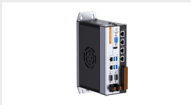
NP-6135-H1B为NP-6135系列中的面向机器视觉行业应用的一款功能型工控机, 外观精巧, 内芯强悍, 可以搭载英特尔®酷睿™10/11代i3/i5/i7系列高性能桌面级CPU, 书本式安装, 占用空间小, 牢固的铝鳍结构, 内嵌风扇辅助散热保证了其在苛刻的环境下工作的稳定性。集成 PoE 千兆网卡、高速隔离DI/DO于一体, 所有接口位于前面, 更加方便接线和维护, 广泛应用于机器视觉检测、缺陷检测、图像识别以及物料分拣等领域。
