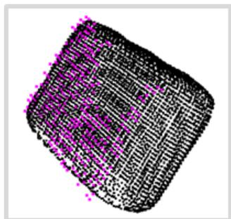
图：深度信息与三维物体模型配准
