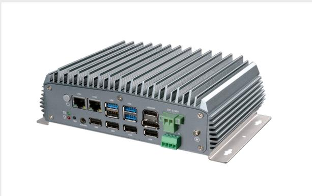
Q-BOX-E9是一款基于X86+FPGA平台适用于运行控制的控制器，采用Intel Elkhart Lake J6412系列低功耗处理器，搭配数量丰富的IO接口，稳固耐用，支持windows 10/11、Linux等多个操作系统。该款机型采用优质铝型材加钣金无风扇散热设计，封闭式无风扇机身散热杜绝传统内置散热风扇及其灰尘造成的故障隐患。整机经过高温、低温、震动、ESD、电磁干扰等严格测试，能够在苛刻的工业环境中长时间稳定运行，为工业制造提供精确、高效的性能。可广泛用于轨道交通、智能交通、工业自动化、生产控制、数据采集、通讯控制、自助终端等领域使用。
