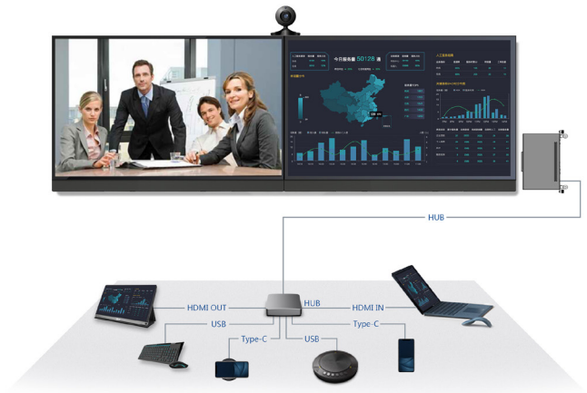
图二 基于德晟达产品设计的一体化视频会议参考方案架构
